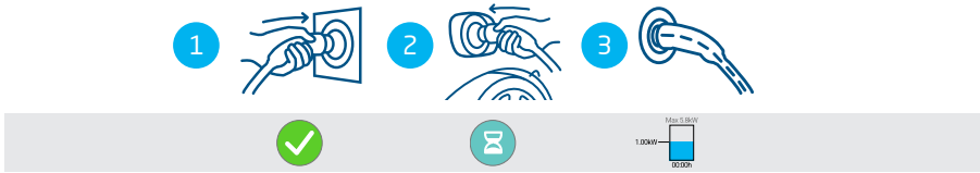
Abbildung 4.1: Starten des Ladevorgangs ohne RFID-Karte. Auf der Anwenderoberfläche angezeigte Symbole
