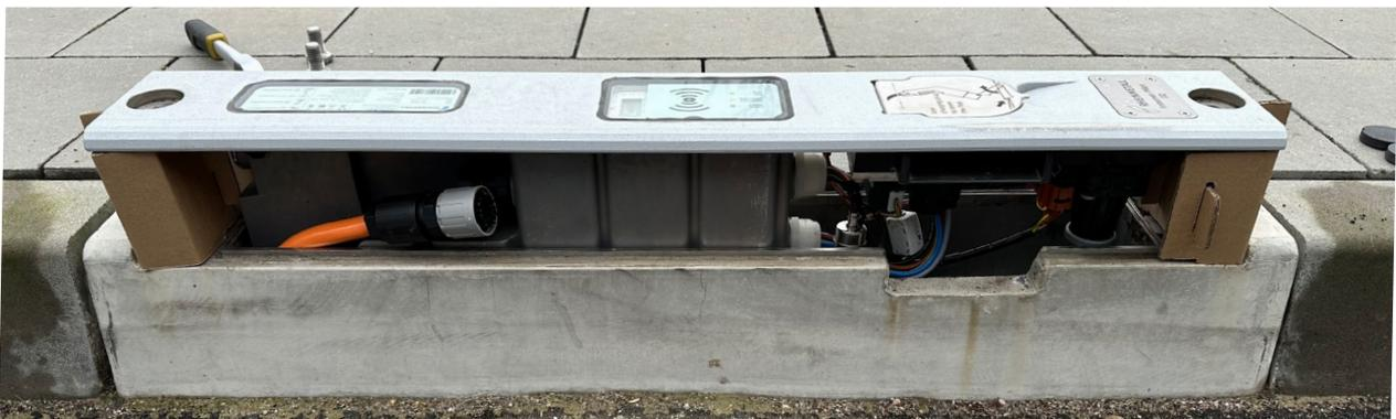
Abb. 32: Elektronikmodul auf den Montageblöcken ablegen
