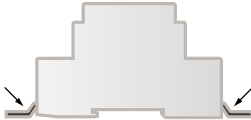
Abbildung 14: Einrastöffnungen für Befestigungsclips
