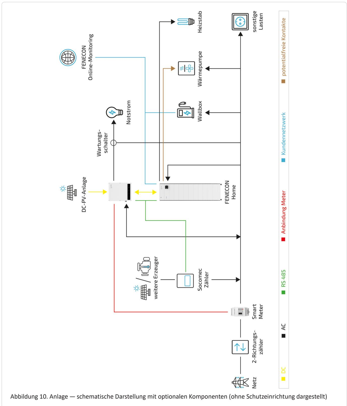
4.2. Systemaufbau: Varianten mit Notstrom
