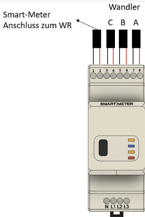
14. Spannungsabgriff an den markierten Anschlüssen vom Energy-Meter anschließen.
