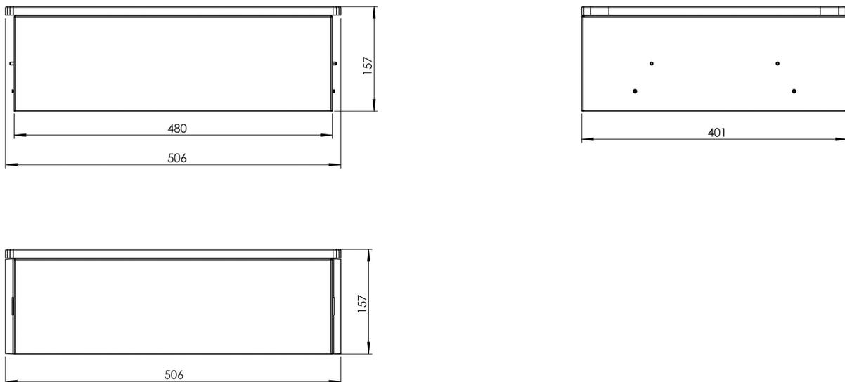
Abbildung 6. Abmessungen — Extension-Box
