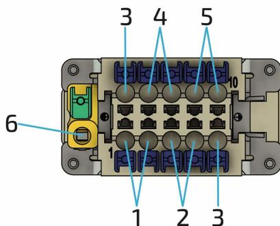
Nachfolgend ist die Pinbelegung des Harting-Steckers (10-polig) im Detail zu sehen.
