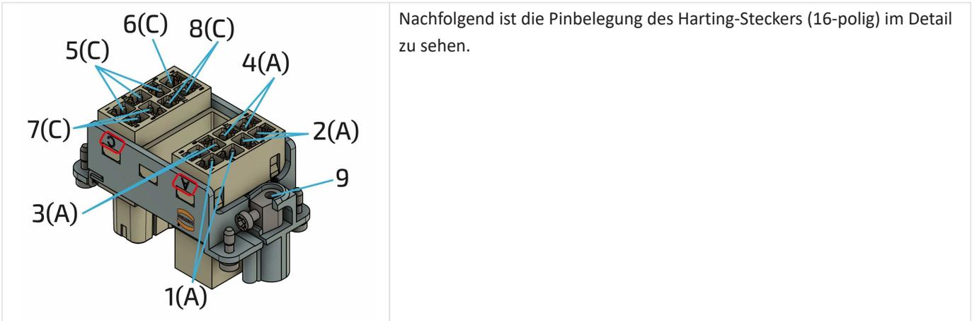
Nachfolgend ist die Pinbelegung des Harting-Steckers (16-polig) im Detail zu sehen.
