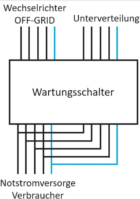
17. Es wird empfohlen, dass ein Wartungsschalter für den Notstromabgang verbaut wird.
