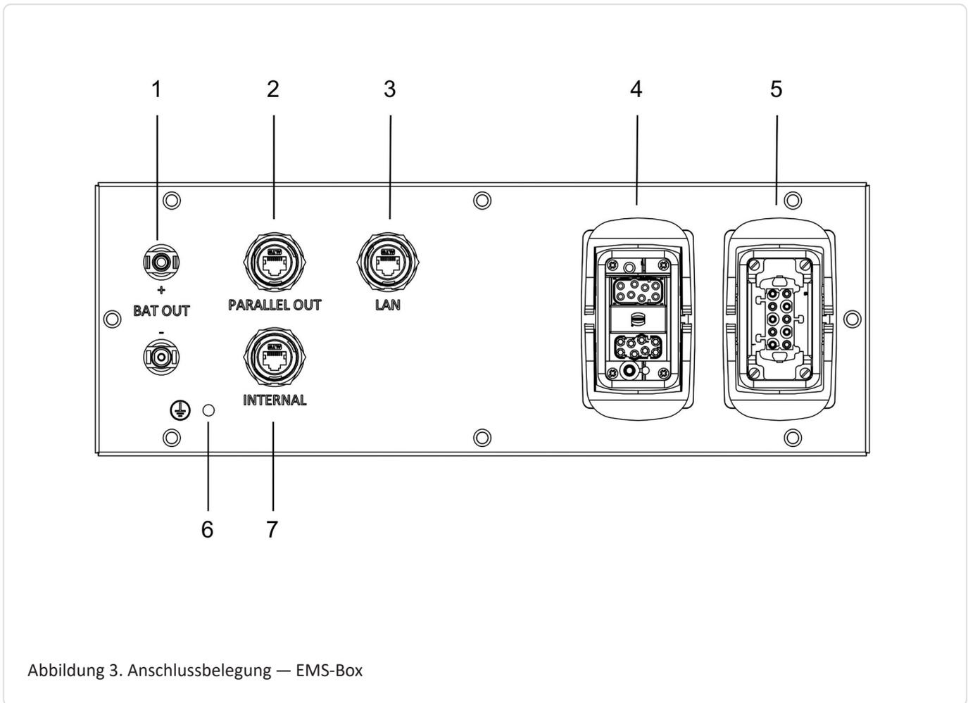
Abbildung 3. Anschlussbelegung — EMS-Box
