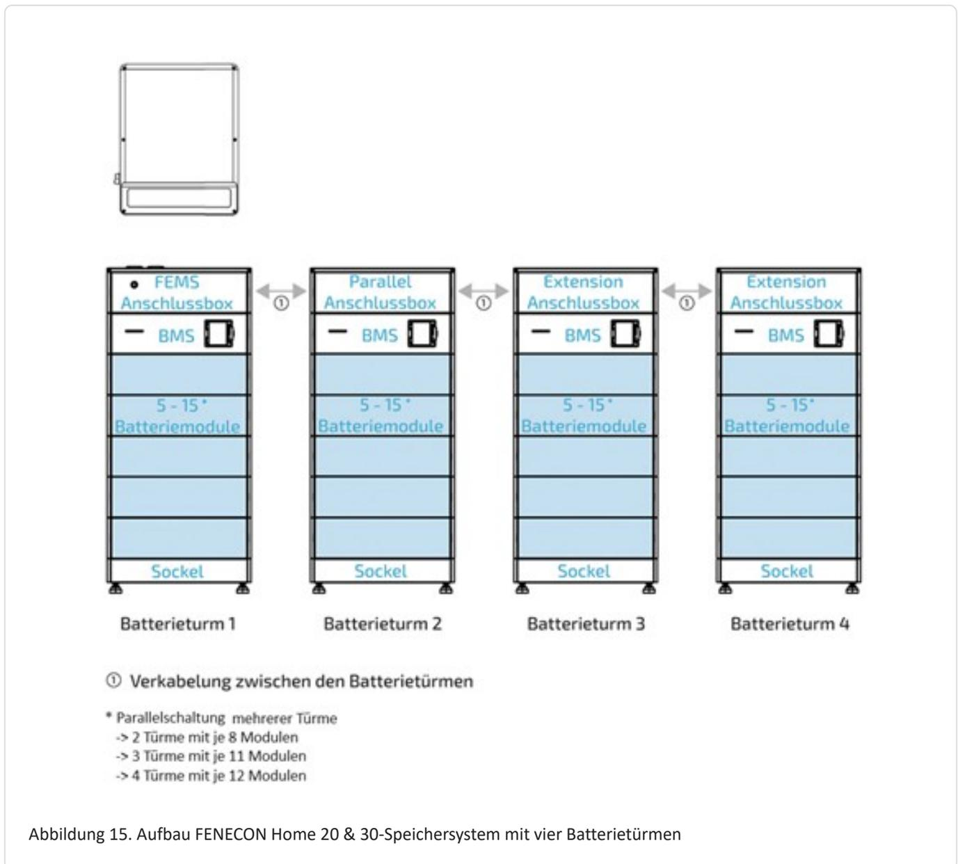
Abbildung 15. Aufbau FENECON Home 20 & 30-Speichersystem mit vier Batterietürmen
