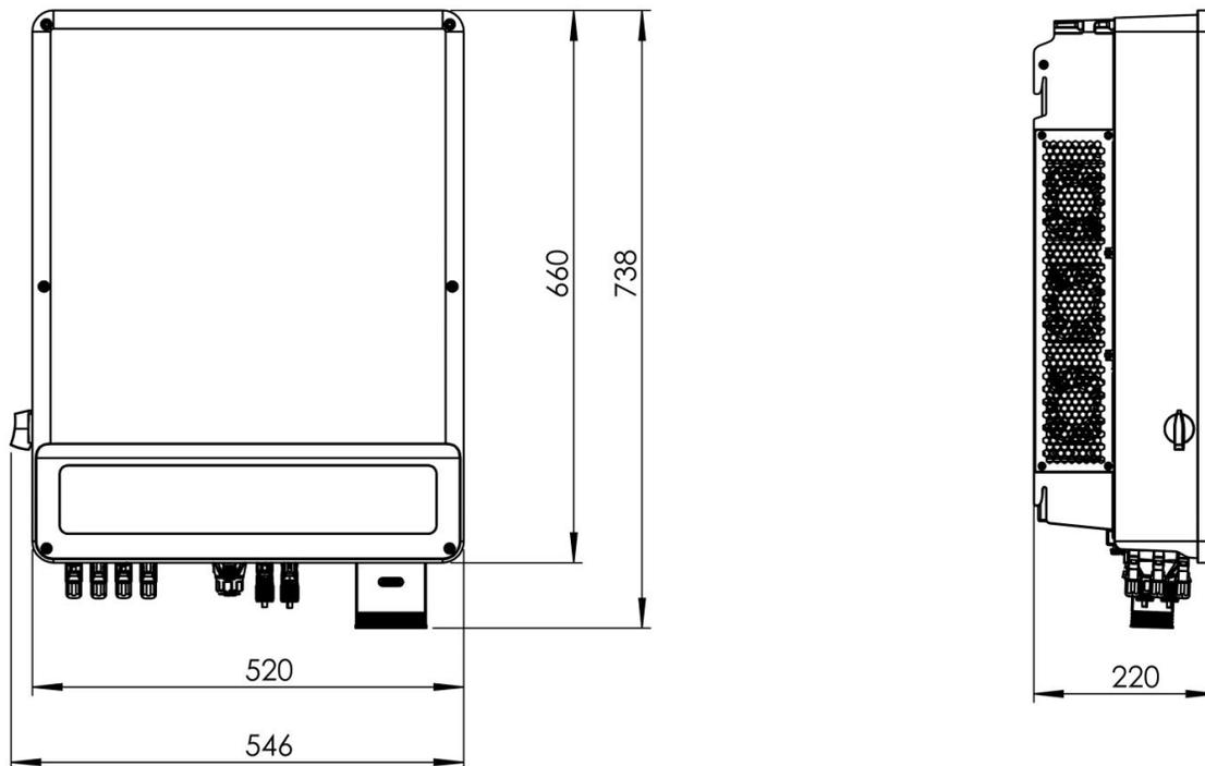
Abbildung 1. Wechselrichter – Abmessungen
