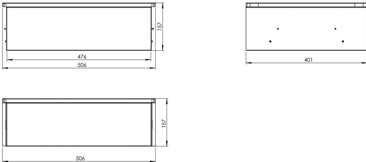
Abbildung 4. Abmessungen — Parallel-Box
