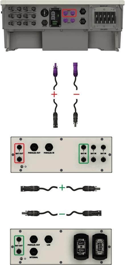
1. Das beiliegende DC-Kabel (3 m) für die Verbindung vom zweiten Batterieturm mit der aufgesteckten Parallel-Box zum Wechselrichter verwenden.
