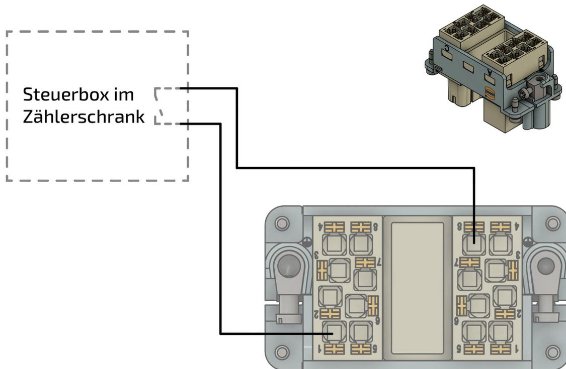
1. Das Signal kann über den Harting-Stecker (16-polig — A & C) an den Pins 1 ( C ) und 8 ( A ) angeschlossen werden.
