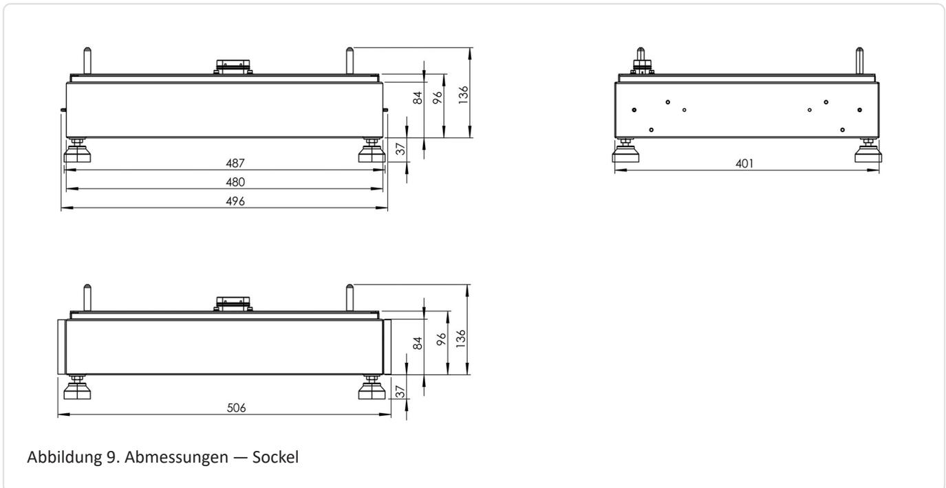
Abbildung 9. Abmessungen — Sockel
