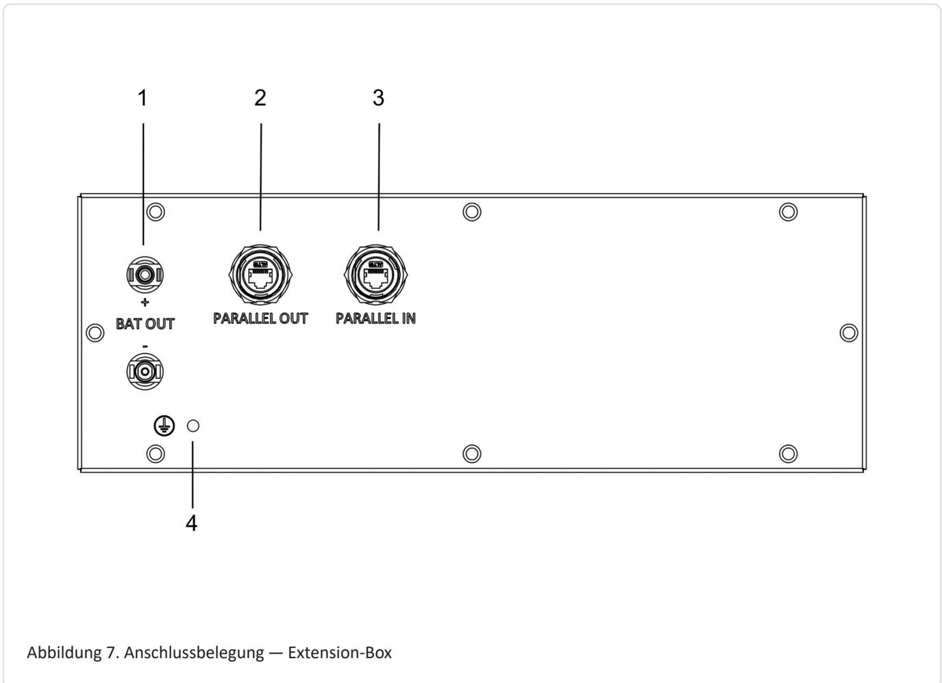
Abbildung 7. Anschlussbelegung — Extension-Box
