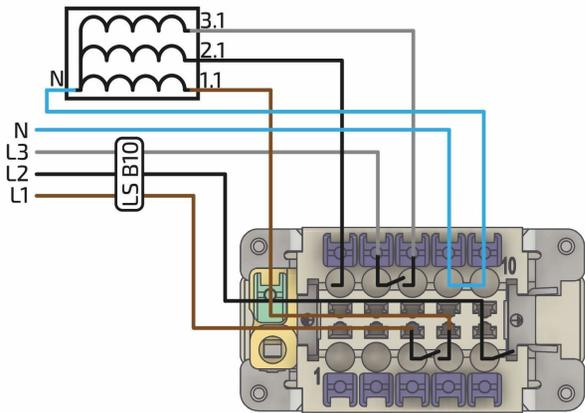
1. Damit jede Phase des Heizstabes separat angesteuert werden kann, muss jede Phase einzeln an einem Relais angeschlossen werden.
