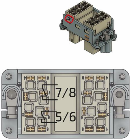
1. Die internen Relaiskontakte 5 und 6 können über die Pins 5/6 und 7/8 am Harting-Stecker (16-polig — C) angeschlossen werden.
