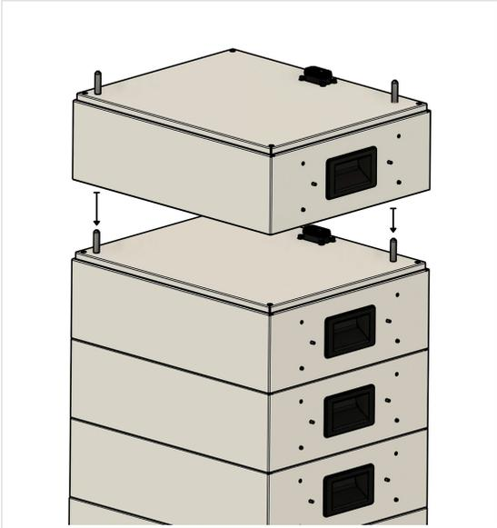
6. Alle restlichen FENECON Home 20 & 30-Batteriemodule auf die gleiche Weise montieren.
