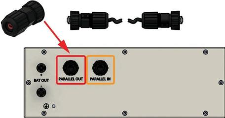
1. Wenn mehrere Batterietürme parallel betrieben werden, dann muss zwischen den Türmen das bei der Parallel-Box und Extension-Box beiliegende Netzwerkkabel verwendet werden (grün).
