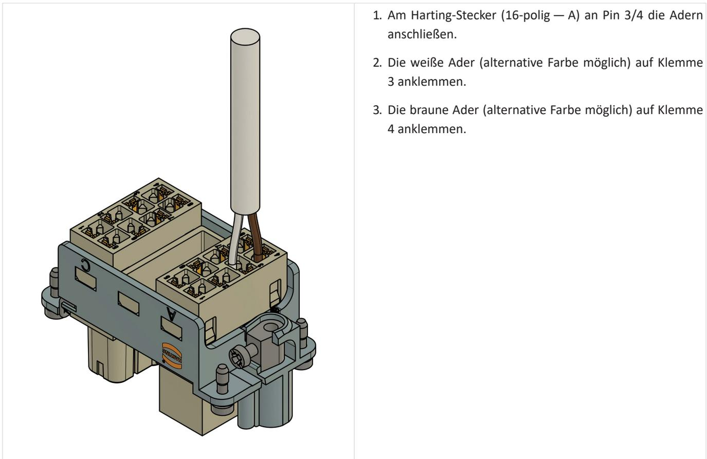
1. Am Harting-Stecker (16-polig — A) an Pin 3/4 die Adern anschließen.
