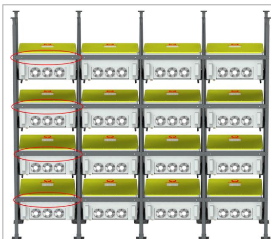
Abbildung 3-13: Ansicht Wechselrichter-Rack 40ft HC-Container
