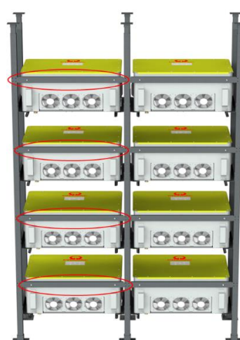
Abbildung 3-14: Ansicht Wechselrichter-Rack 20ft HC-Container
