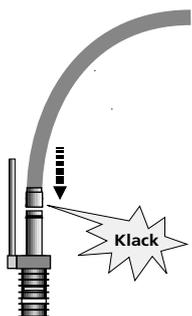
**2 Mantelrohr-System auf Rohrstützen schieben.**
