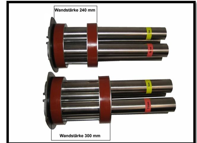
Die Modelle **UNISELECT UK T 240** und **UNISELECT UK T 300** sind für die am häufigsten gebauten Wandstärken ausgelegt. Für 240 mm und 300 mm Wandung. Das ausgeklügelte Verspannungssystem ermöglicht es, beide Dichtungen parallel in der Wand über die Betätigung von 5 Schraubenköpfen im Kellerraum zu montieren.
