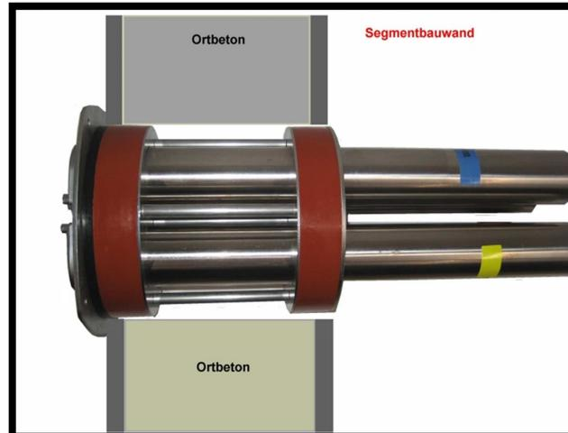
Die Mehrspartenhauseinführung gründet sich auf ein seit 20 Jahren bewährtes Ringraumdichtungs-Montageteil mit hoher Festigkeit. Die vier kompletten Schutzrohre sind in einer Edelstahlplatte eingeschweißt. Die Dichtigkeit zur Kernlochbohrung oder zum Schutzrohr wird über zwei Ringraumdichtungen hergestellt.
