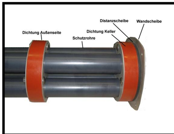
Hier ist die an der Außenseite befindliche Ringraumdichtung als Einzelteil konzipiert und muss separat montiert werden. Beide Ringraumdichtungen sind bis 4 bar wasserdicht. Die Schutzrohre haben eine Länge von 600 mm Länge, so dass auch dickere Mauerstärken problemlos abgedeckt werden können.
