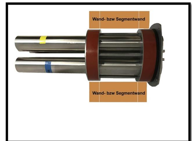
Zunächst wird die Edelstahlfrontplatte der Burger® Mehrspartenhauseinführung UNISELECT UK T an der Kellerwand nach Einschieben in die Kernlochbohrung verdübelt. Die Belegung der Hauseinführung mit den Medienleitungen ist denkbar einfach. Die Rohre und Kabel werden einfach von innen durch die Edelstahrohre geschoben und mittels der Salinoflansche druckwasser- und gasdicht verschraubt.
