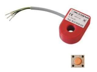
Der DC-Wächter besitzt einen Test-Knopf zur Überprüfung der Fehlerstromschutzeinrichtung. Bei Betätigen wird ein 6 mA DC-Fehlerstrom generiert. Daraufhin erzeugt der DC-Wächter einen AC-Fehlerstrom, welcher den im Verteilerschrank platzieren RCD auslöst.
