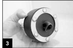
3 Mit Werkzeug abgewinkelte Lamelle zur anderen Seite durchdrücken.
