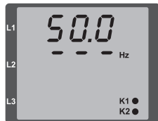
Abb. Keine Drehfeldrichtung feststellbar.
