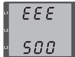
Abb. Warnmeldung mit Nummer 500 (Netzfrequenz)
