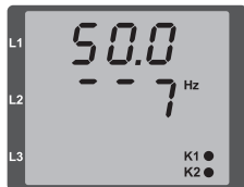
Abb. Anzeige der Netzfrequenz (50.0) und der Drehfeldrichtung
