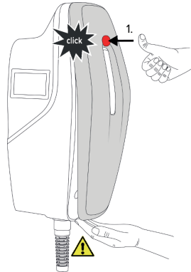
Afb. 18: Frontcover aanbrengen (voorbeeld) - 1
