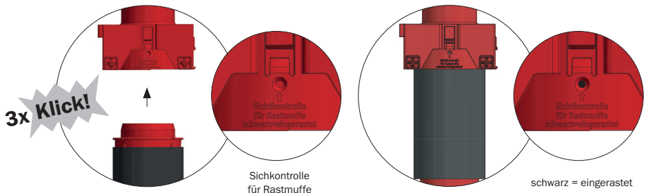
Abbildung 5.1: Anschluss KRASO® FLS 90
