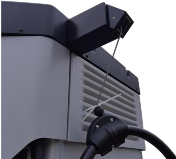
Bild 5-34 Seilklemme entlasten
