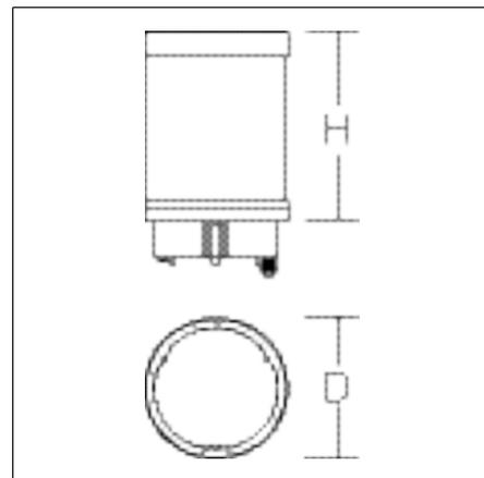
Leuchtenkopf für Pollerleuchte für den öffentlichen Bereich. Leuchtenkopf aus korrosionsbeständigem Aluminium-Druckguss, seewasserbeständig pulverbeschichtet, Edelstahl Schrauben. Abdeckung aus pulverbeschichtetem Aluminium-Druckguss mit opalem Glaszylinder. Befestigung des Leuchtenkopfs auf Standrohr über Bajonett. Modulbauweise: Zum Leuchtenkopf ist ein Standrohr immer erforderlich. Bitte separat bestellen! Bitte Kabelübergangskasten separat bestellen.
