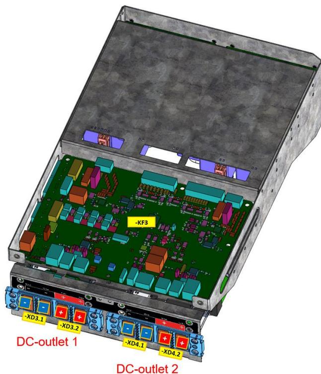
Abbildung 22: DC-Ausgangsschaltanlage des HYC200 (Ansicht von oben)
