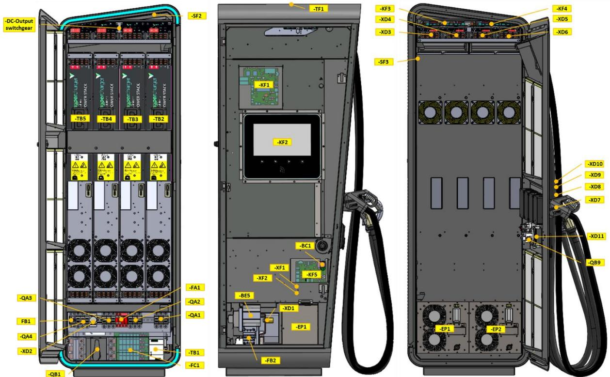
**Abbildung 15:** Innenansicht hypercharger HYC400 (Service-, Display-, Ladekabelseite)
