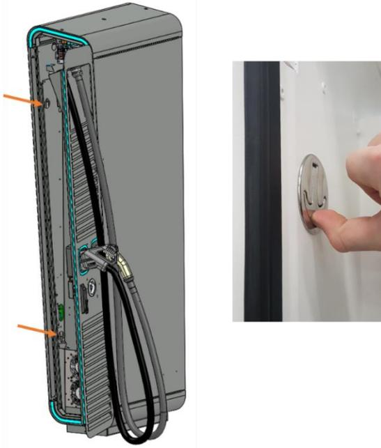
**Abbildung 13:** Verriegelungsmechanismus für die Displaytür
