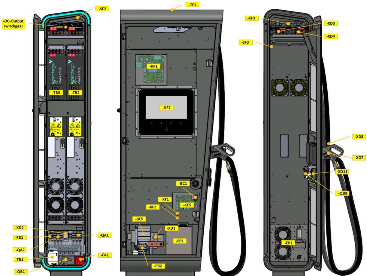
**Abbildung 14:** Innenansicht hypercharger HYC200 (Service-, Display-, Ladekabelseite)
