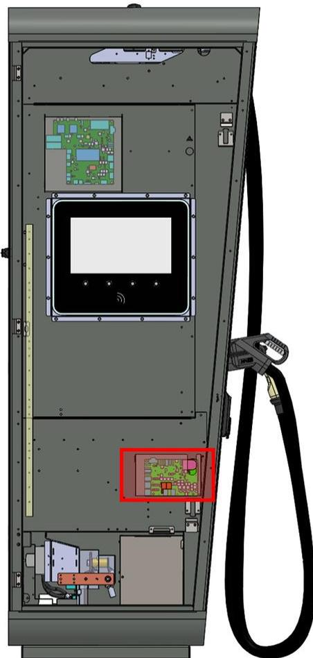
**Abbildung 28:** Position der CTRL\_EXT im hypercharger
