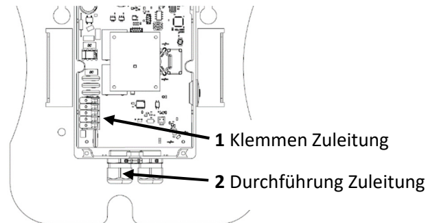
Abbildung 4 Klemmstellen innerhalb der Wallbox
