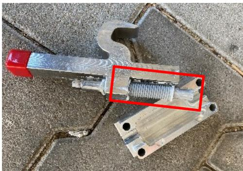
ABBILDUNG 41: SPINDEL SCHMIEREN
