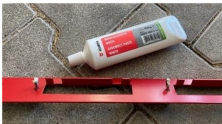
ABBILDUNG 104: SCHRAUBEN DER MODULVERRIEGELUNGEN SCHMIEREN
