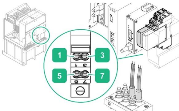
ABBILDUNG 66: PILOTKABEL ANSCHLIEßEN
