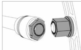
Solange fortfahren bis sich die oberen Muttern abdrehen (ITL-Prinzip: Integrated Torque Limiter; kein Spezial-Werkzeug nötig.)
