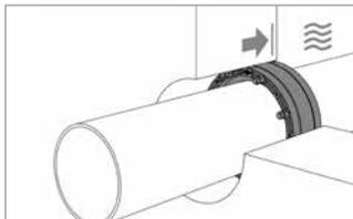
... bis der Dichtungseinsatz etwa bündig mit der Außenwand (Wasser-/Druckseite) abschließt.
