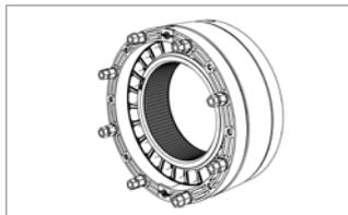
Das weiße Gewebeflies (in der Gummidichtung > Abdichtung zum Medienrohr) ist nicht zu entfernen.
