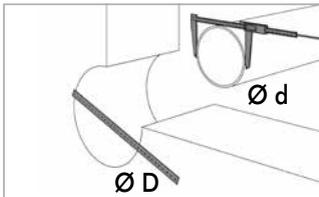
Durchmesser von Kernbohrung bzw. Futterrohr und der Medienleitung bestimmen und mit den Angaben auf dem Karton abzugleichen.
