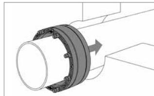
Curaflex Nova® Senso auf die Medienleitung und in Kernbohrung/Futterrohr einschieben ...
