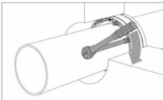
Zur Endmontage des Dichtungseinsatzes die Muttern (SW 10) anziehen.
