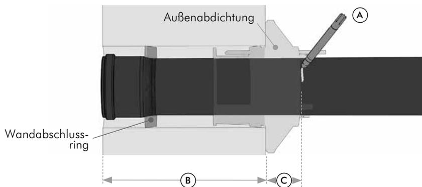
Die Lage des Kanalgrundrohres ist hierbei entsprechend des geplanten Rohrleitungsverlaufes zu positionieren.
