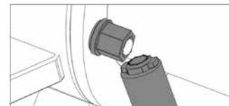
Solange fortfahren bis sich die oberen Muttern abdrehen (ITL-Prinzip: Integrated Torque Limiter; kein Spezial-Werkzeug nötig.) Zur Endmontage die ITL-Muttern (SW10) anziehen
